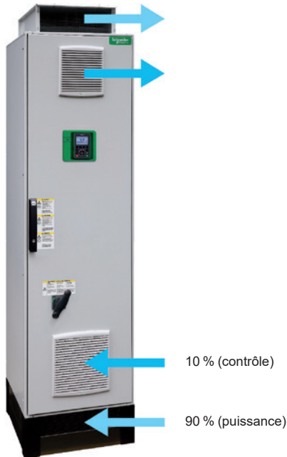
Système de refroidissement avec deux flux d'air séparés
