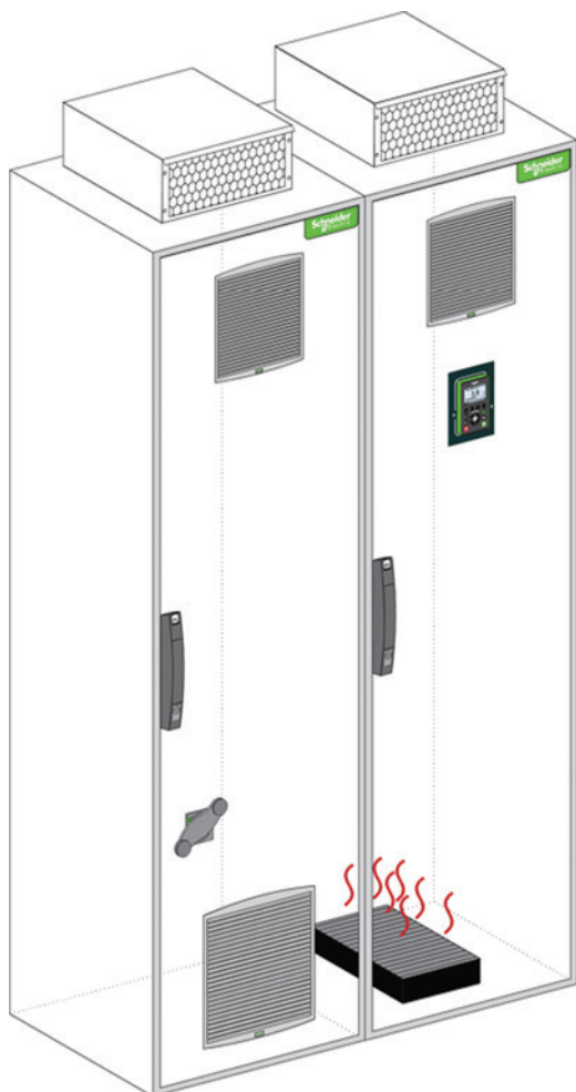
Chauffage de l'armoire
